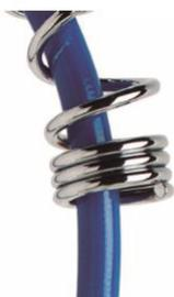
Sistema de muelle fabricado en acero inoxidable AISI 304 cromado, regulable en altura con giro de 360°. Flexo de alta resistencia a la presión, con tubo interior de PEX, malla interior de acero inoxidable y funda plástica para facilitar la limpieza. Doble grapaje en acero inoxidable AISI 304 y tuercas giratorias fabricadas en latón cromado.
