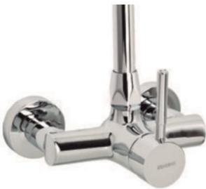
Grifo mural mezclador monomando de cocina profesional para ser usado con caño o columna. Cuerpo en latón CC754S cromado según EN 248. Dotado de cartucho cerámico mezclador D40 y válvulas antirretorno. Incluye todos los elementos de fijación.
